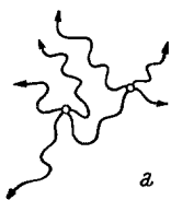
Abb. 3a. Verknüpfung mehrerer Ketten durch weniger als zwei Vernetzungsstellen pro Kette. Abb. 3b. Verknüpfung mehrerer Ketten durch mehr als zwei Vernetzungsstellen pro Kette: echte Netzstruktur.
