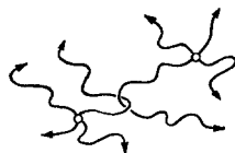
Abb. 4. Durch Kettenverschlingung zusätzlich verknüpfte Ketten.
