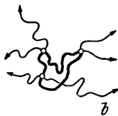
Abb. 3a. Verknüpfung mehrerer Ketten durch weniger als zwei Vernetzungsstellen pro Kette. Abb. 3b. Verknüpfung mehrerer Ketten durch mehr als zwei Vernetzungsstellen pro Kette: echte Netzstruktur.
